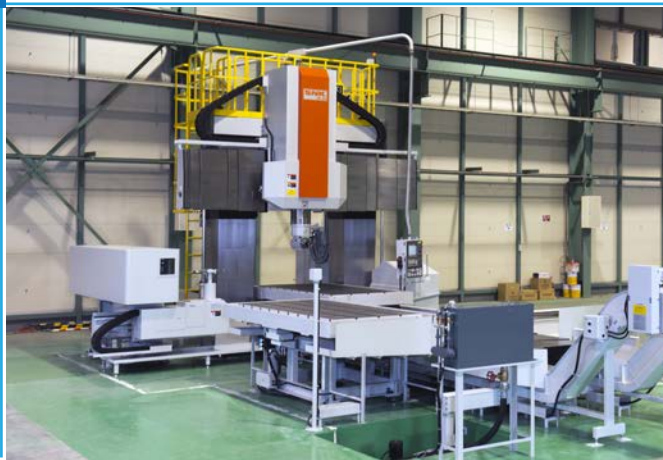
門型五面加工機 新日本工機 RB-2M
